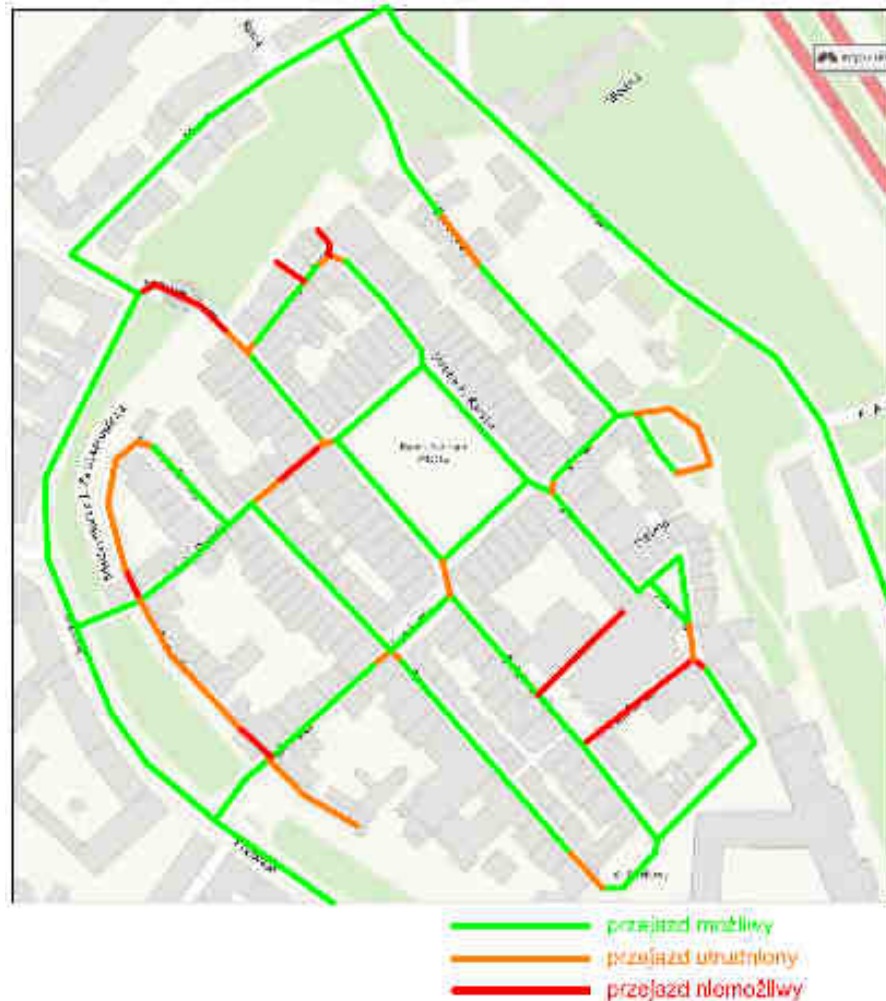
1. Lokalizacja dróg dojazdowych wraz z oceną stopnia trudności poruszania się samochodów pożarniczych na terenie Starego Miasta (oprac. ekspert zewnętrzny)
